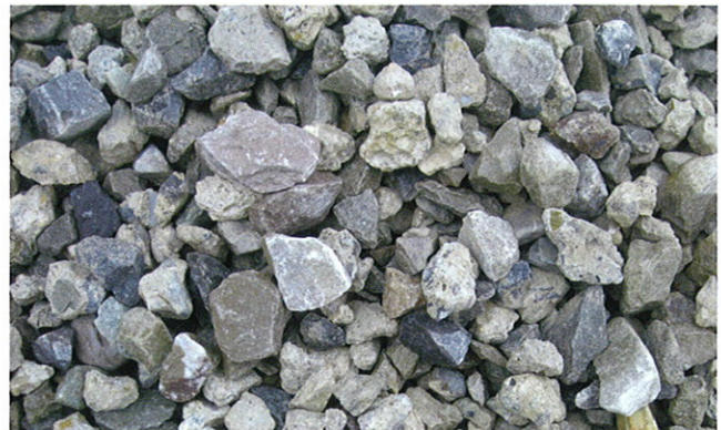
Granulats recyclés pour la fabrication des Ecobétons® de structure
